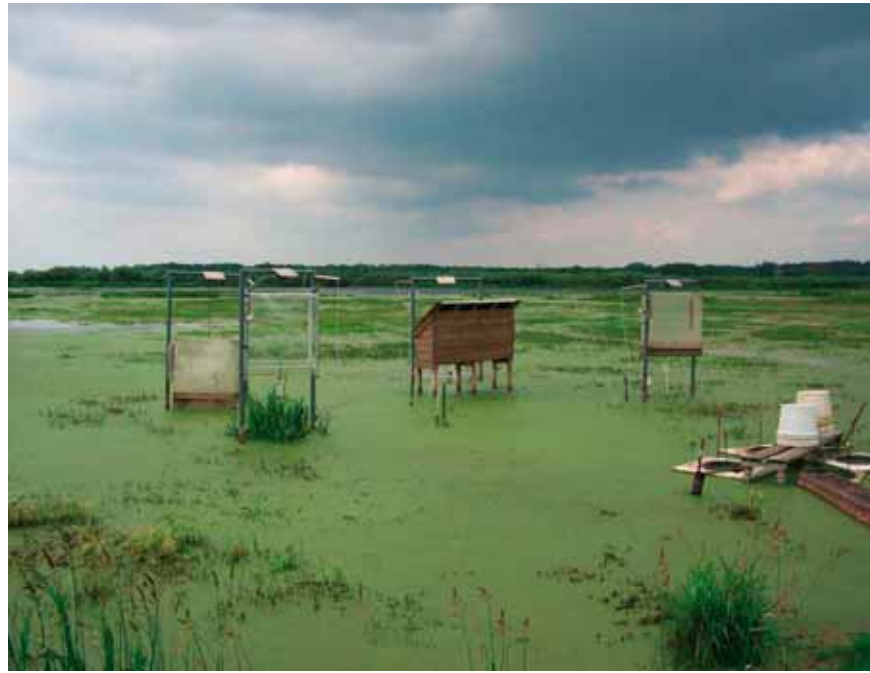
Abb. 2: Gasaustausch-Messstelle in überstautem Niedermoor, Juni 2006 (Foto: J. Augustin)
