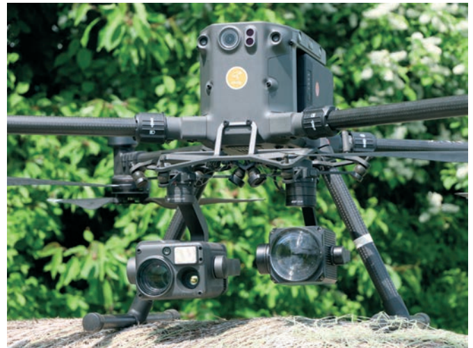
Abb. 10: Drohne mit mehreren Sensoren (Foto: OGF, 2024)
